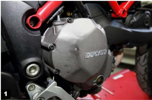
▲ Schrauben und andere Stahl- oder Leichtmetallkomponenten zeigten keine Spuren von Oxidierung. Karosserie, Motor und Rahmenlackierung waren in Topform mit Ausnahme des rechten Kurbelgehäuses im Bereich des Kupplungsdeckels, wo der Kontakt mit dem Stiefel zu Abrieb geführt hatte.
