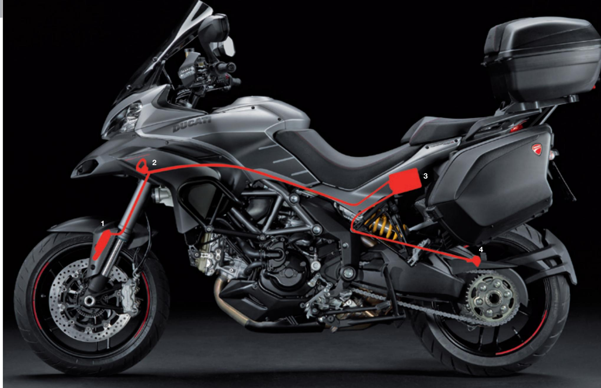
Die ECU verwaltet die Informationen aus den Beschleunigungsmessern, aus der Position des Gashebels und dem ABS (über CAN), um die Stoßdämpferventile abhängig vom Riding Mode und den Inputs von der Straße konstant optimal zu regeln: Schlaglöcher, Stöße, Bremsvorgänge, Beschleunigung usw.
