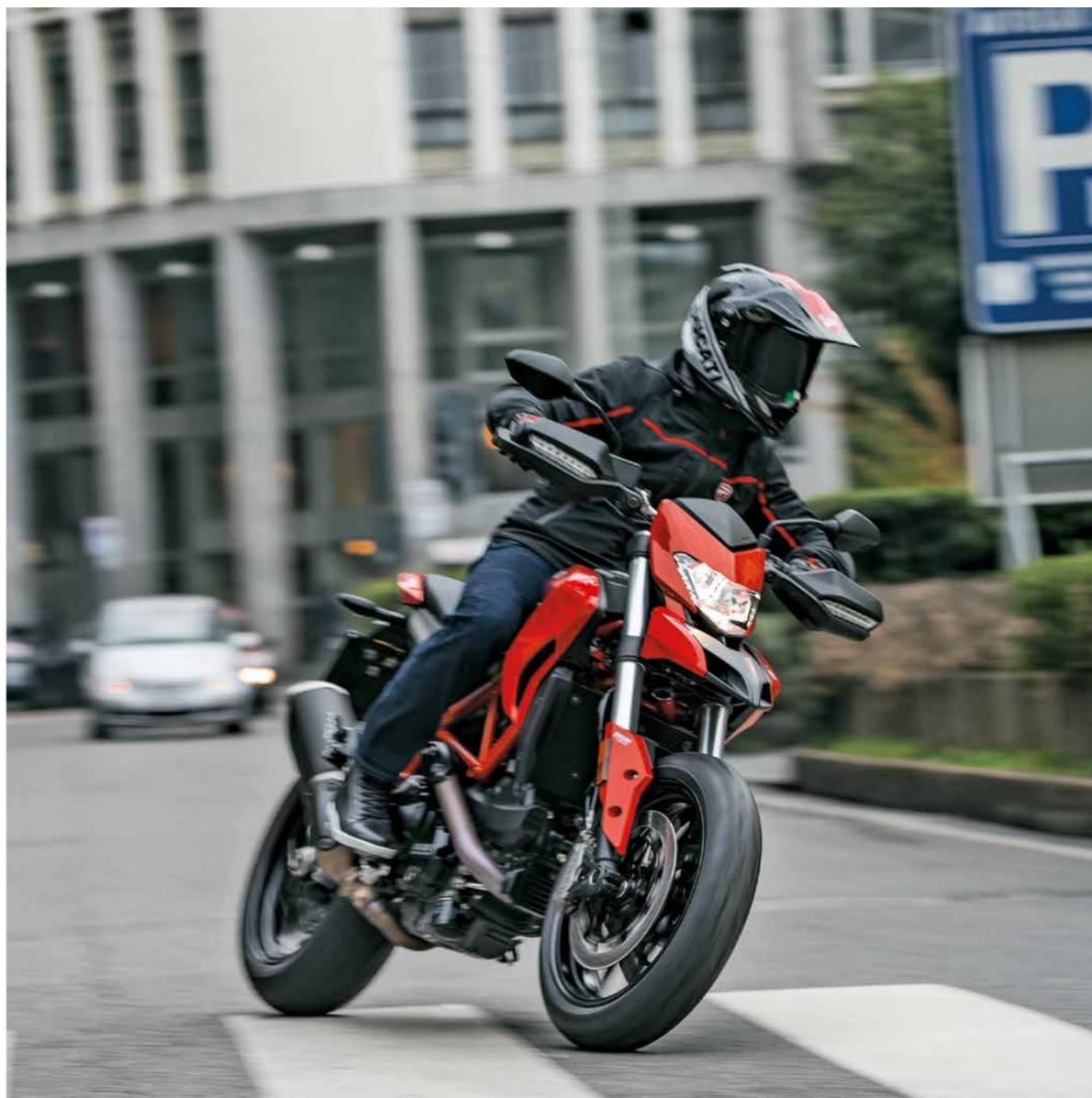
Mit seinem Gewicht von nur 204 kg im fahrbereiten Zustand und dank des besonderen Augenmerks auf die Ergonomie für den Fahrer, gewährleistet die Hypermotard 939 eine Fahrerposition mit der maximalen Kontrolle. Die Sitzbank ist 870 mm hoch, als Ducati Performance Zubehör ist allerdings auch eine 20 mm niedrigere Sitzbank erhältlich.
