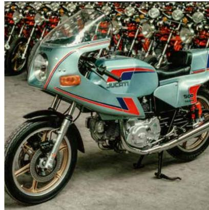
Einführung der 500 Pantah mit dem neuen Riemenantriebssystem und dem Gitterrohrrahmen.
