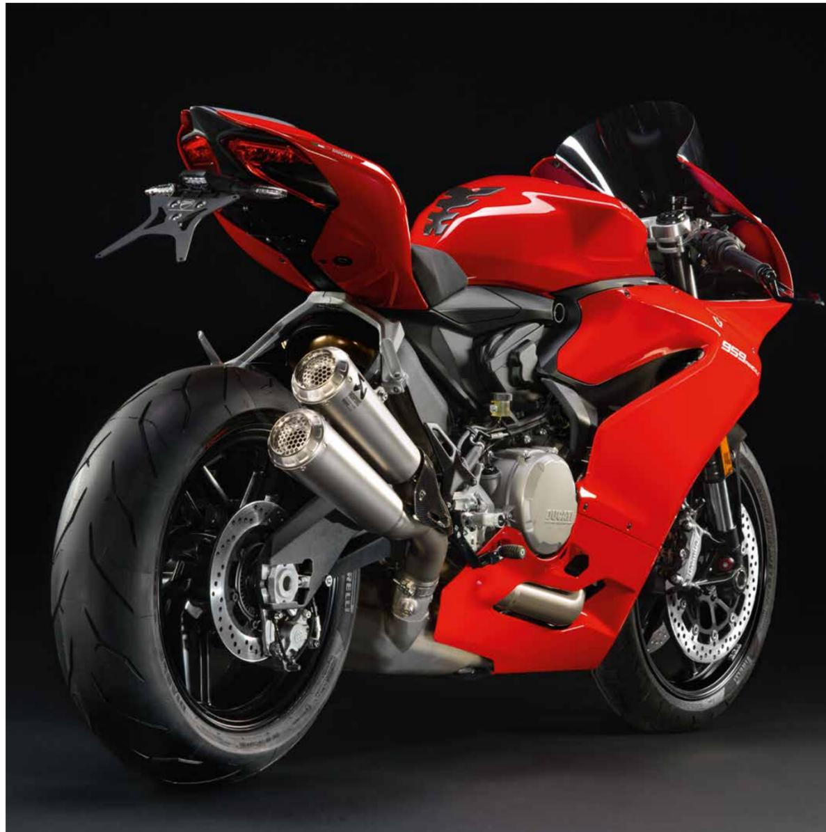
Neuigkeiten auch im Hinblick auf die Auspuffanlage: an der Version „World“ wird für die Euro 4 Zulassung ein doppelter seitlicher Schalldämpfer montiert. An der Version für die Märkte, in denen Euro 4 nicht erforderlich ist, befindet sich die Auspuffanlage unter dem Motor und ist mit der Verkleidung verbunden. Für alle diejenigen, die sich nicht zufrieden geben, sind Nachrüst-Alternativen von Akrapovič aus besonders leichtem Titan erhältlich.
