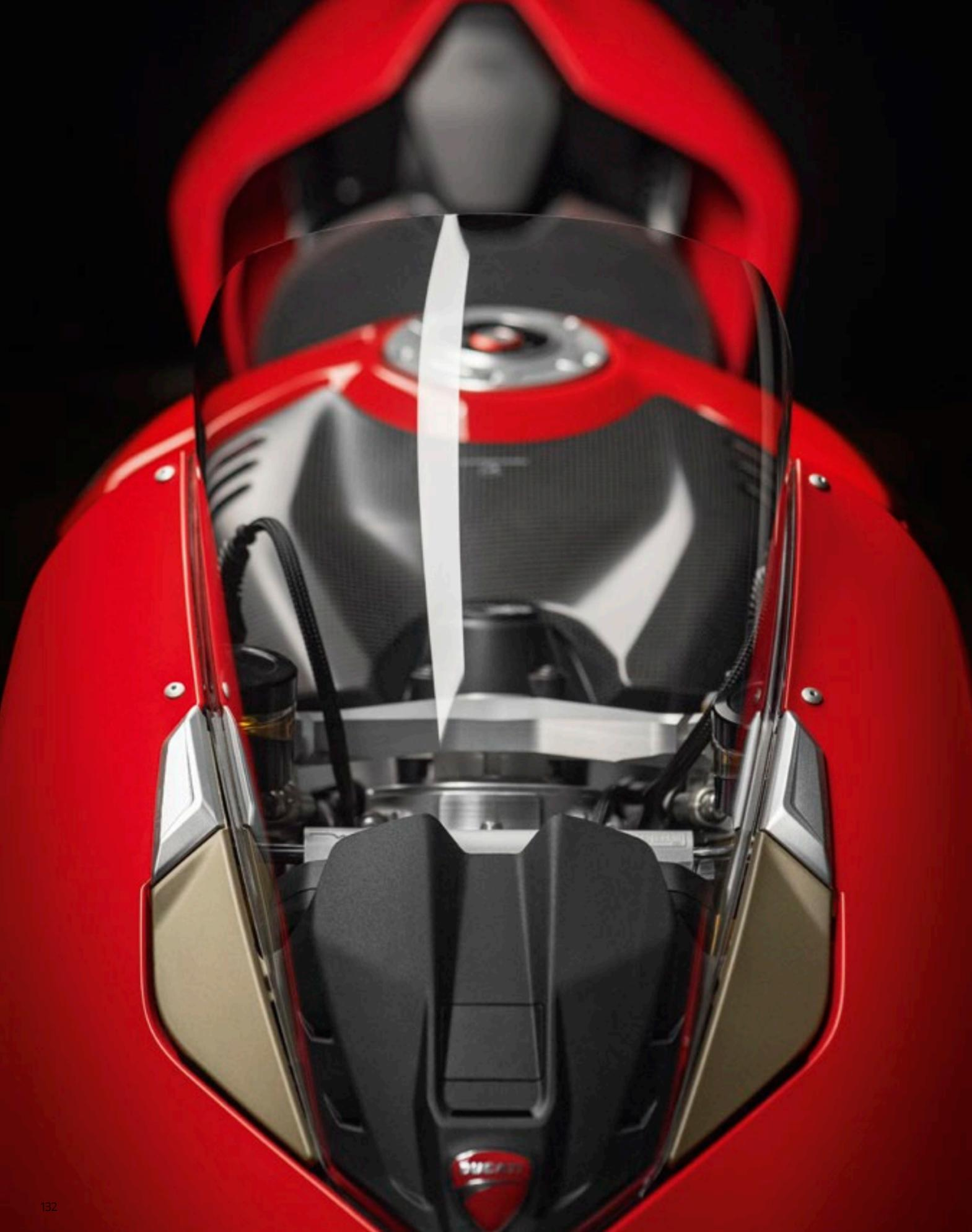
Erhöhte und abgedunkelte Plexiglasscheibe für höheren aerodynamischen Schutz
