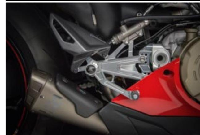
Verstellbare Fußrasten aus einem Stück Aluminium
