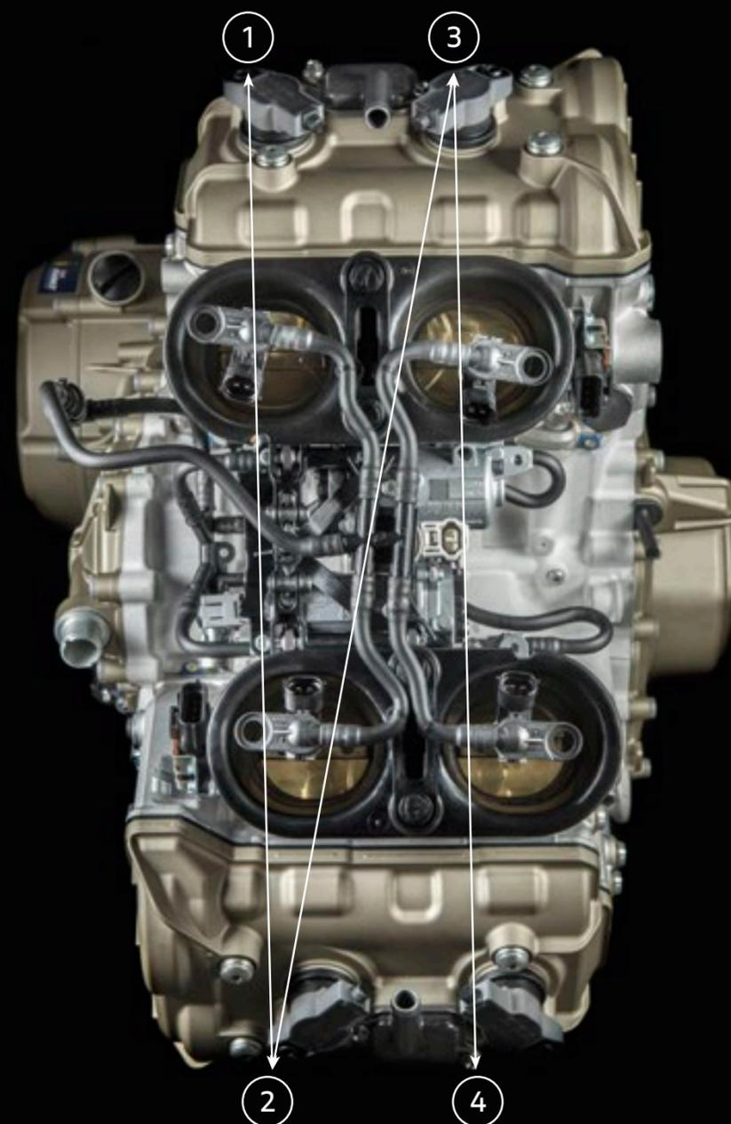
Der Hubzapfenversatz von 70 Grad führt zusammen mit der 90°-V-Bauweise zu einer Zündfolge, die typisch für Zweizylindermotoren ist (die sogenannte „Twin Pulse“-Zündfolge). Diese Zündfolge sorgt für erhebliche Vorteile in Bezug auf die Leistungsabgabe bei gerader Fahrt und beim Herausbeschleunigen
